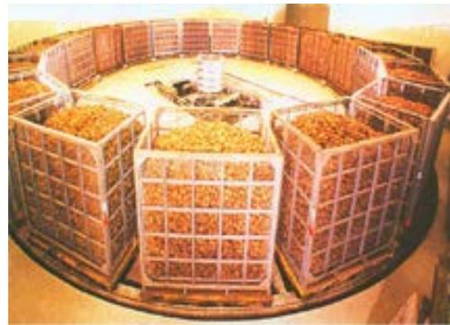
写真2（馬鈴薯照射設備内部）
